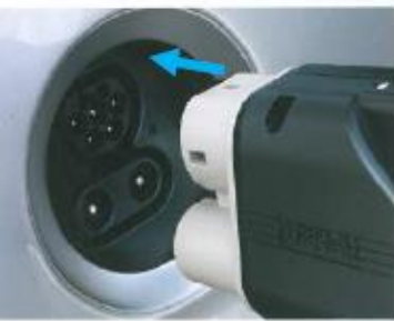
Priključite konektor na vozilo
